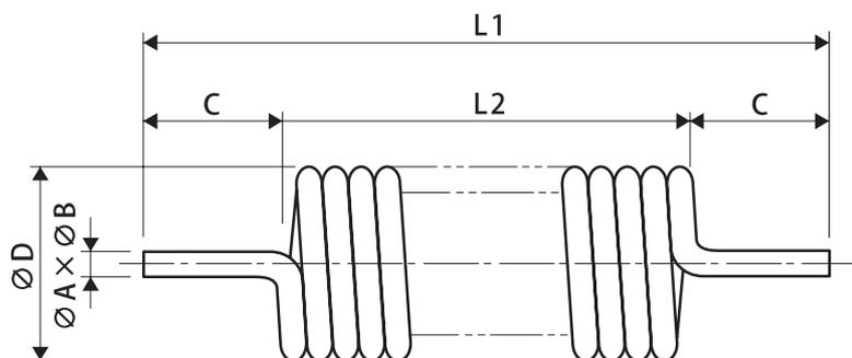
$\text{ØA} \times \text{ØB}$  : 外径 × 内径
